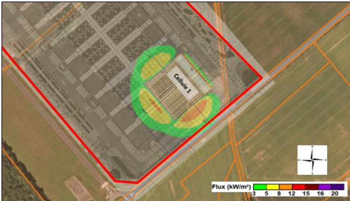
Figure 93 : Cartographie de l'AM1 – Incendie de la cellule 1
